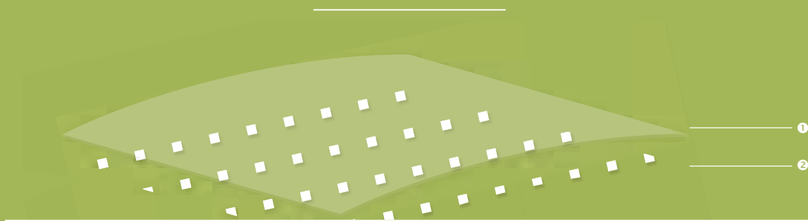
1 transparente PVC-Folie 2 bedruckter Rücken & Standardbeschichtung
